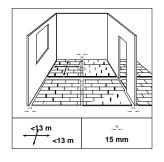
大房间在横宽方向和纵长方向每隔 13 m 都须为板条设伸缩缝。膨胀和收缩都是线性的,所以表面积越大,所需容差就越大。
