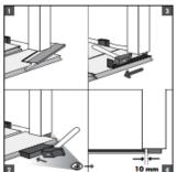
锯切板条时,请确保门板下方的伸缩缝至少为 10 mm。如果无法举起板条,请使用调整过的敲击块或铁橇和敲击锤,将板条敲击拼合在一起。
