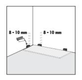
铺设木板,锯断面靠墙。将取自安装套件的垫片放在板材和墙壁之间,此举可确保伸缩缝有足够的宽度: 8 至 10 mm。
