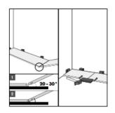
放置要安装的板条,使其与已铺设的板条成 20 到 30 度角。上下轻移待此板条,同时向前施力。板条将自动接合到位。将 Uniclic 敲击块放在板条间的短接缝旁,仔细轻敲,直至板条完全对准。
