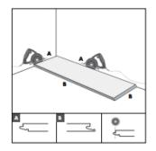
在第一排铺一整块板材。锯掉第一个板条的长榫舌和短榫舌。
