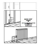
这款 Quick • Step®地板的主材是木材。因为室内湿度时有变化,例如夏季和冬季湿度不同,地板能够膨胀和收缩是极为重要的。这正是为何必须在地板各侧留有至少 8 到 10 mm 的伸缩缝,管道周围、门板下方和门阶处也是同一道理。请记住,地板可在一个方向移动。
