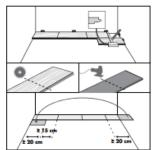
当然,还需要锯切板条。为了准确切割,使用线锯或手持圆锯时,板条顶面应该朝下,而使用手持锯或横切锯时则板条顶面应该朝上。确保连续两排板条的端面接缝不在一条直线上。务必确保接缝错开至少 15 cm。
