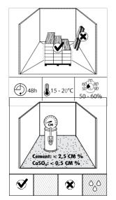
将未拆包装的板材放在即将安装地板的房间中央,在正常室温条件下静置 48 小时,以适应环境。理想条件是 15-20℃(59-68°F),相对湿度 50-60%。
