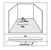
确保地板基底平坦。任何高于 2 mm、长度超过 1 M 的不平坦处,都须抹平。
