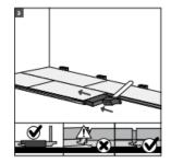
使用 Uniclic 敲击块将这些板条之间的横缝敲击拼合在一起。确保两个板条在毛地板上水平同高,并确保放置敲击块的位置如图中所示,以避免损伤。
