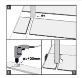
在装有管道的位置,确保管道下落方向充分对准两块板条间的接缝。取一个直径等于管道直径加 20 mm 的钻头。将板条的短边契合,然后在两块板条之间的接缝中间位置钻孔。现在,您可以开始在地面上安装板条了。
