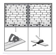
此外,最后一排板条与墙壁之间还须留有 8 到 10 mm 的伸缩缝。锯切最后一排板条时,请务必切记此点。在极难用敲击块安装 Unilic 板材的位置(例如靠墙处),可用铁橇和敲击锤将板材敲击拼合。
