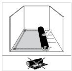
先撤走所有不防潮的地面覆盖物(地毯、针轧毛毡,等等)。防潮的地面覆盖物(PVC、油毡,等等)则无需撤走。请务必使用地垫。建议您使用 Quick• Step®地垫。
